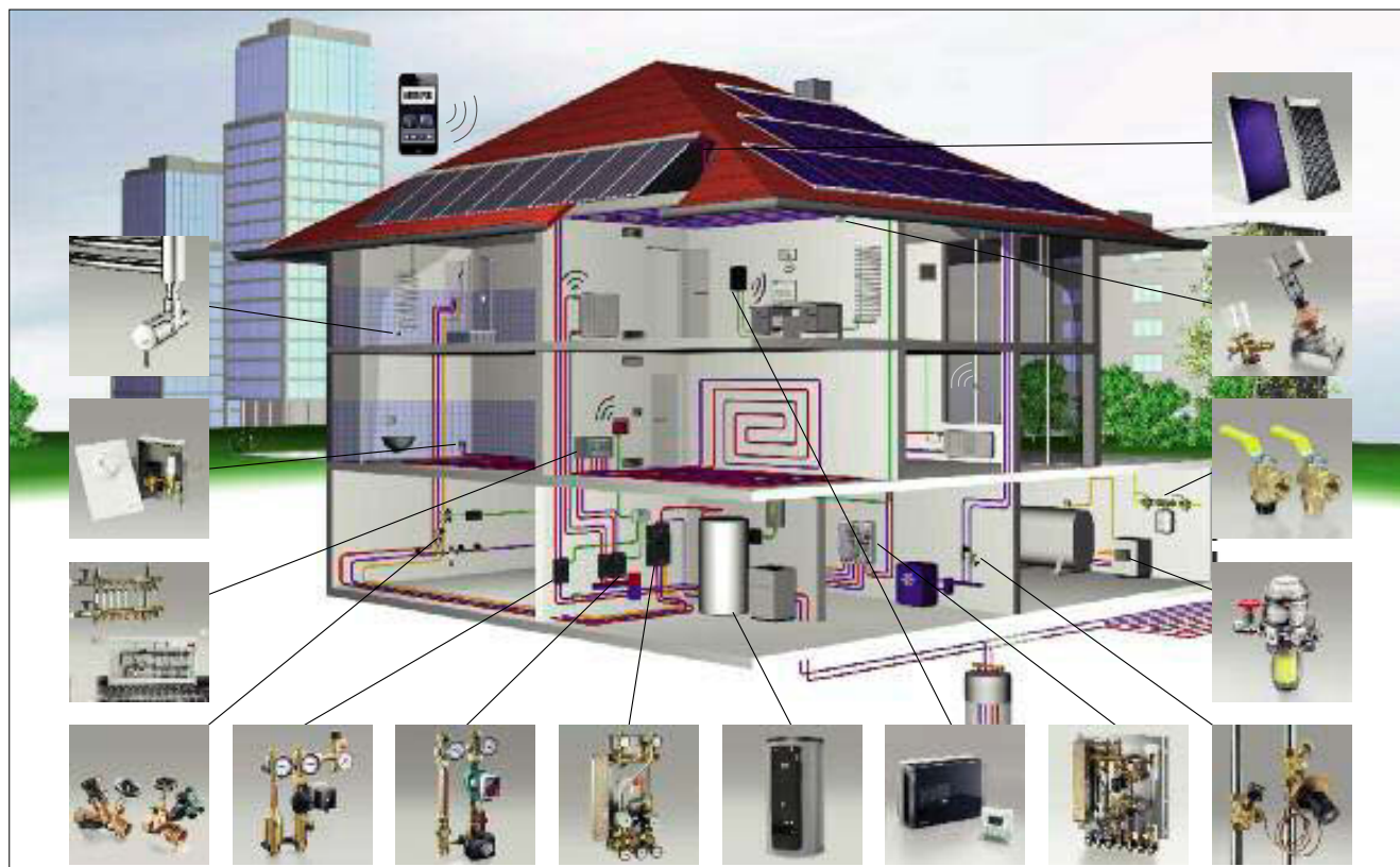
Beispiel: Aufbau einer Solarthermie im Einfamilienhaus
