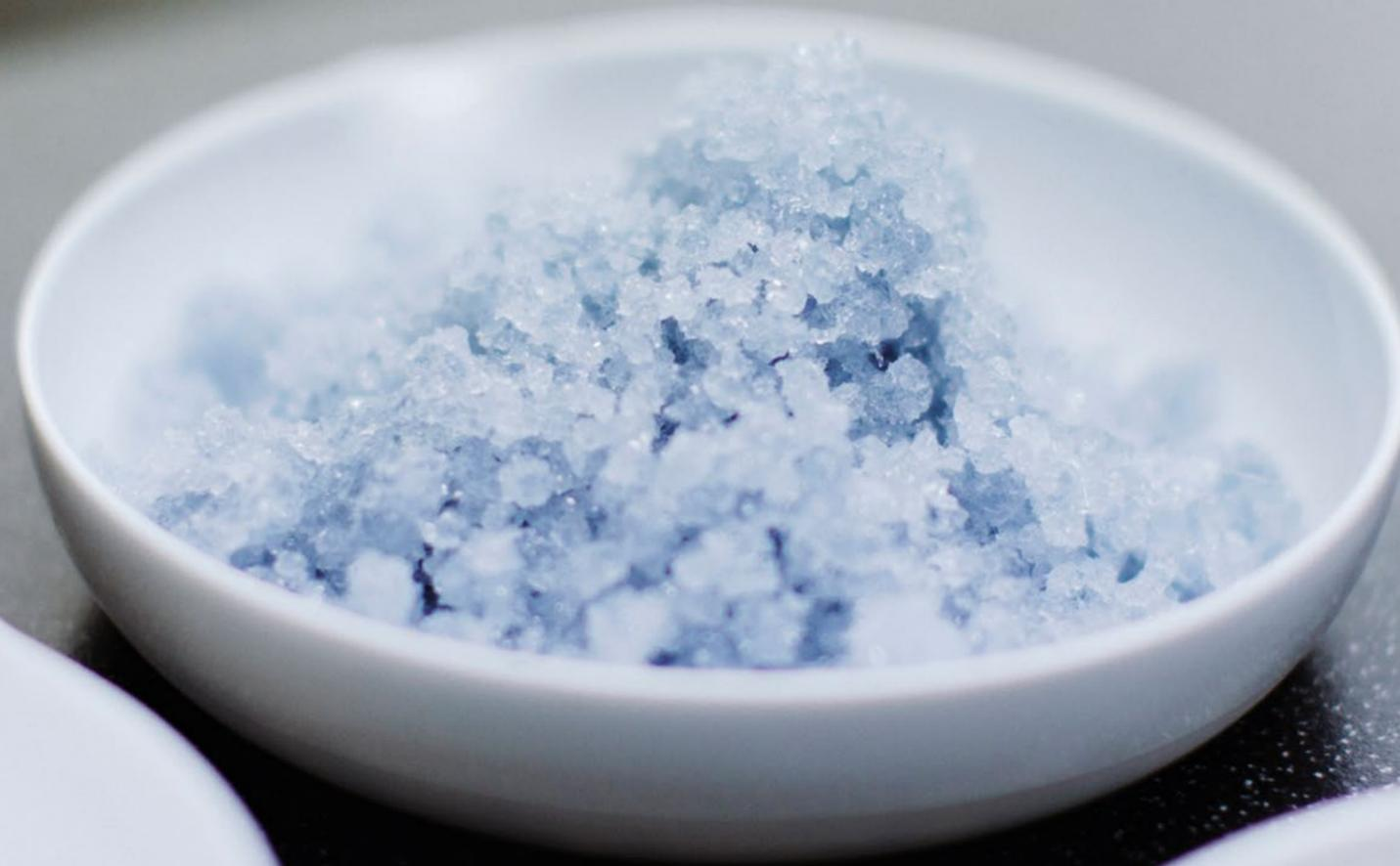
DIE BEI KALDEWEI PRODUZIERTE EMAILLE FRITTE IST EIN GROBPULVRIGES GLAS, WELCHES SPÄTER GESCHMOLZEN UND AUF DEN STAHLKÖRPER AUFGETRAGEN WIRD. BEI HOHER HITZE WIRD DIE FRITTE MIT DEM STAHL VERBUNDEN. DAS ERGEBNIS SIND ÄSTHETISCH GLATTE, GLASARTIGE OBERFLÄCHEN MIT HÖCHSTER WIDERSTANDSKRAFT GEGEN ABRIEB UND KORROSION.
