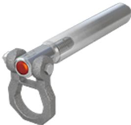
Das Prinzip hinter unserer Absturzsicherung ABS-Lock I+II lautet: Eine Anschlagöse für mehrere Anschlageneinrichtungen. Das System basiert auf 2 Elementen. Der ABS-Lock I ist ein abnehmbarer Anschlagpunkt, der mit einem Knopfdruck eingesetzt und ebenso unkompliziert wieder abgenommen wird. Sobald die Sperrkugeln des Anschlagpunkts arretieren, hält er problemlos Belastungen von 2 Tonnen und mehr stand. Er eignet sich damit bestens zur Fensterabsturzicherung.
