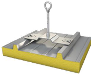
Der witterungsbeständige Sekurant ABS-Lock X-SW-6 punktet mit seiner unkomplizierten Montage von oben. Mit 6 Schrauben wird die Grundplatte des Anschlagpunktes über zwei Sicken montiert, exakt über den darunter liegenden Holzbalken oder Z-Pfetten. Die Schrauben werden einfach durch Blech und Dämmschicht in die tragende Unterkonstruktion gesetzt - selbstverständlich liefern wir Ihnen die Schrauben gemäß Ihren Angaben in der passenden Länge dazu.
