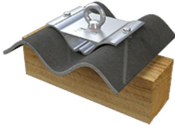
Der ABS-Lock Wave ist ein Edelstahl-Anschlagpunkt mit einer wellenförmigen Aluminiumgrundplatte. Er fügt sich optimal in die Profile von Wellplattendächern (etwa der Marke Eternit) mit einem Wellenabstand von 177 mm. Montieren Sie diese Anschlageinrichtung mit nur 2 Schrauben direkt im Dachsparren: Dabei genügt eine Mindeststärke von 80 x 120 mm.
