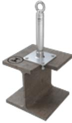
Sie benötigen einen Einzelanschlagpunkt mit 400, 700 oder 1000 mm Überstand? Mit dem ABS-Lock X-SR-ST kein Problem. Der Sekurant ist in Schritten von je 100 mm standardmäßig in den Längen zwischen 300 bis 1000 mm verfügbar. Weil die Anschlageinrichtung mit einem verschweißten Stützrohr ausgestattet ist und durch Stahl gekontert wird, ist sie ein echtes Kraftpaket und hält 3 stürzende Personen zu gleicher Zeit.
