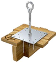
Der Einzelanschlagpunkt ABS-Lock X-H-14+2 für Holzschalungen ab 24 mm Stärke dient bis zu 3 Personen als Rückhaltesystem oder Auffangsystem. Die plastisch verformbare Anschlagvorrichtung ist für eine Querbelastung entwickelt und wird auf dem Boden montiert. Der Sekurant basiert auf einer Stütze (Ø 16 mm), die sich bei einer Sturzbelastung umlegt und so die Hebelwirkung vermindert. Auf den Befestigungsuntergrund wirken dann nur noch geringe Schubkräfte, die problemlos absorbiert werden.
