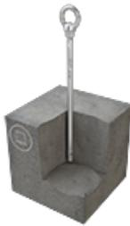
Einhämmern, Dübel spreizen, sofort einsatzbereit. Mit dem Personenanschlagpunkt ABS-Lock III-BE Pro wird die Montage von Absturzicherungslosungen auf dem Flachdach noch einfacher. Denn die Verankerung im Beton benötigt nur ein Bohrloch. Der Spezialdübel des Edelstahl-Sekuranten wird vom Kopf aus mit einem Handgriff aufgespreizt. Ein Drehmomentschlüssel genügt.
