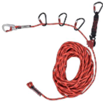
ABS Lanyard - temporäres Seilsicherungssystem Kantengeprüftes Kernmantelseil mit Seilkürzer, Bandfalldämpfer und Karabinerhaken
