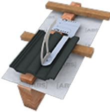
Eine Grundplatte mit 2 x 7 Bohrlöchern macht die Montage des ABS-Lock DH05 besonders flexibel. Der Dachhaken wird mit nur 2 Schrauben im tragenden Balken verschraubt und so ausgerichtet, dass er perfekt in die Wölbung der Ziegel passt. Die benötigten Edelstahlschrauben sind im Lieferumfang enthalten.
