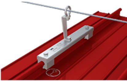
Mit dem ABS-Lock Falz IV Rundbördelfalz ZW führen Sie das Edelstahl-Seil Ihres Seilsicherungssystems über Hindernisse. Der Zwischenhalter wird beispielsweise eingesetzt, um das Seil über den erhöhten Dachfirst zu führen, sodass es nicht aufliegt.
