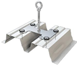
Mit dem ABS-Lock X-T-21 reduzieren Sie den Montageaufwand Ihrer Absturzsicherung. Der Anschlagpunkt / Sekurant wird mit 4 vormontierten Kippdübeln geliefert, die Sie ganz bequem einzeln von oben durch die Löcher der Grundplatte (290 x 200 mm) stecken. Die Absturzsicherung für Warmdächer bietet 3 Personen eine zuverlässige Anschlagmöglichkeit, die als Rückhaltesystem und Auffangvorrichtung genutzt werden kann.
