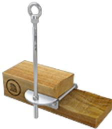
Mit 2 Edelstahlschrauben durch den Sparren gekontert, schützt die Absturzicherung ABS-Lock III-Seitl-65 gegen Stürze. Der Edelstahl-Sekurant hat eine Winkelplatte für die seitliche Montage und ist für die gleichzeitige Nutzung von 3 Personen getestet.
