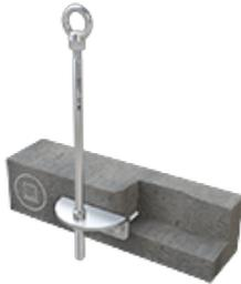
Der Anschlagpunkt ABS-Lock III-SEITL-65 zum Einbetonieren hat eine Winkelplatte für die seitliche Montage. Seine 2 Ankerstangen werden mit unserem Verbundmörtel WIT-VM-250 (ZU-1000) im Untergrund befestigt. Der Sekurant sichert nach fachgerechter Montage bis zu 3 Ihrer Mitarbeiter gleichzeitig an Absturzkanten.
