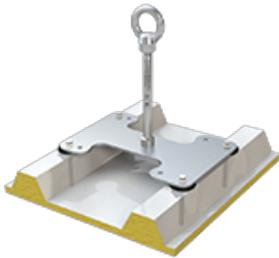
Mit dem Sekuranten ABS-Lock X-SW haben Sie eine Absturzicherung für Sandwichdächer zur Hand, die unkompliziert von oben montiert wird. Dafür bohren Sie einfach 4 Löcher, entfernen mit einem Schraubendreher (o. ä.) etwas von der Dämmung unter der Dachhaut und stecken die Kippdübel hinein. Voraussetzung für die Montage des Sekuranten ist eine Mindeststärke der Sandwichprofile (Stahl) von 0,5 mm.
