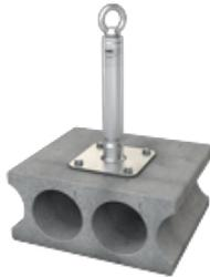
Mit 4 speziellen Hohlblechankern (Spreizdübeln) befestigen Sie den Sekuranten ABS-Lock X-SR-HD sicher auf Rippen- und Beton-Hohldecken. Der Montageuntergrund benötigt dafür eine Güte von mindestens C45/55 (B55). Sie können den Anschlagpunkt in verschiedenen Größen zwischen 300 mm und 1000 mm ordern. Der erforderliche Überstand variiert abhängig von der Dacheindeckung und dem geplanten Auffang- oder Rückhaltesystem.
