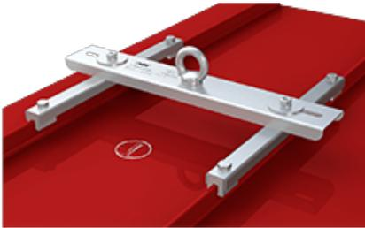
Dieser Edelstahl-Anschlagpunkt ABS-Lock Falz IV Klip wird einfach auf die Metallfalze (z. B. KlipTec, Snapfalz etc.) geklemmt und sichert 3 Personen gegen Absturz. Möglich wird das mit speziellen Aluminiumklemmen, die eine Öffnung der Dachhaut unnötig machen. Nach fachgerechter Fixierung der Klemmen sitzt der Sekurant fest auf der Dachhaut.
