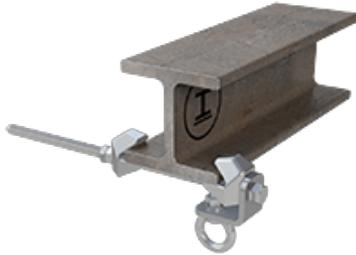
Unkompliziert montiert, fast unverwüstlich. Der Anschlagpunkt ABS-Lock T wird mit seinen Trägerklemmen um den Flansch Ihrer Stahlträger geklemmt und kann dann flexibel als Absturzsicherung verwendet werden. Der ABS-Lock T sichert als einzelner Sekurant bis zu 3 Personen, ist in jede Richtung belastbar und außerdem als Systemkomponente in Seilsicherungssystemen sehr variabel nutzbar: als Zwischenstütze, Kurventräger oder Befestigung für Endterminals.
