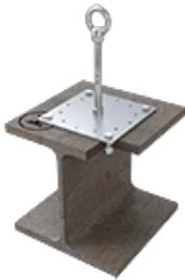
Die Grundplatte (200 x 200 mm) des Sekuranten ABS-Lock X-ST wird mit 4 Edelstahlschrauben und Muttern durch tragende Stahlträger gekontert. So montiert, dient der Edelstahl-Anschlagpunkt (Ø 16 mm) als Auffangsystem oder Rückhaltesystem für maximal 3 Ihrer Mitarbeiter in Arbeitsbereichen mit Absturzgefahr.
