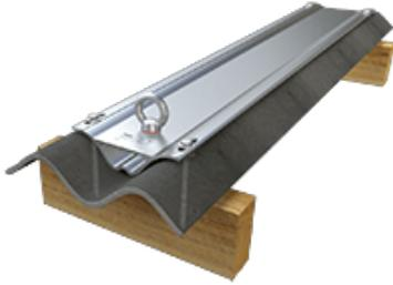
Diese spezielle Anschlagereinrichtung für Wellplattendächer kann bereits ab einer Sparrenbreite von 60 x 120 mm verbaut werden. Der ABS-Lock Wave 60 hat eine 125 cm lange Grundplatte und wird mit vier Schrauben an zwei Sparren befestigt. Die ausgelieferte Standardlänge ist dabei auf einen Sparrenabstand (Balkenmitte bis Balkenmitte) von 115 cm ausgelegt.
