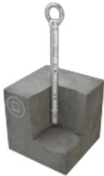
Mit dem ABS-Lock III-BE Pro-24 wird die Montage und jährliche Überprüfung einer individuellen Absturzicherungslösung zum Kinderspiel: Für die dauerhafte Befestigung genügt eine einzelne Bohrung in den Betonuntergrund des Flachdaches. Der Spezialdübel am unteren Ende der Stütze wird aufgespreizt, indem Sie mit einem handelsüblichen Drehmomentschlüssel die Mutter am oberen Ende anziehen (170 Nm).
