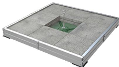
Mit dem ABS Weight OnTop Double errichten Sie flexibel Seilsicherungssysteme auf Flachdächern bis 5° Dachneigung - und das, ohne die Dachhaut zu öffnen. Denn diese Anschlagereinrichtung wird mit 16 Betonplatten (jeweils 50 x 50 x 5 cm zu 28 kg; nicht im Lieferumfang) beschwert. Die Auflast wird auf einen nur 150 x 150 cm großen Rahmen aufgebracht, in den ein Netz aus PE-Gewebe gespannt ist. Das ist eine echte Platzerparniss. Im Vergleich zu herkömmlichen Auflast-Produkten.
