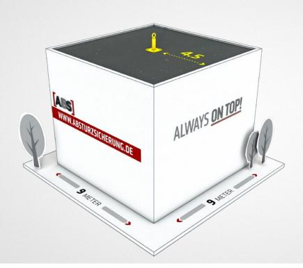
Der Abstand vom Zentrum zur Dachkante beträgt 4,5 Meter (direkter, kürzester Weg). Bei einem Sturz aus der Ecke entsteht daher eine maximaler Pendel von 1,86 Metern. Zuzüglich der Körpergröße und dem maximalen Aufriss des Bandfalldämpfers von 1 Meter ist aufgrund der Gebäudehöhe also immer noch ausreichend Freifallhöhe vorhanden.
