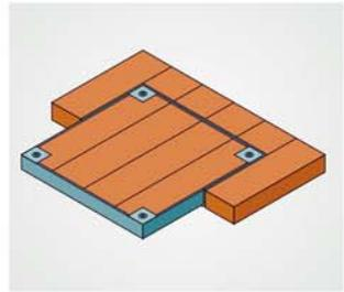
Der Deckel kann an diesen Punkten mit dem Hebeschlüssel auch heraus genommen werden. Eine Befüllung mit Holz und Hartbodenbelägen oder anderen Materialien ist möglich.
