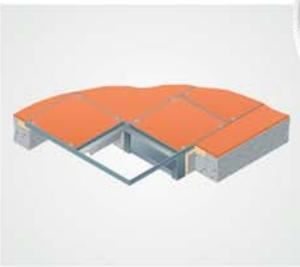
Die Zarge wird bodengleich einbetoniert. Anschließend kann die Wanne befüllt werden und in die Zarge eingelegt werden. Die Befestigung des Deckels an der Zarge erfolgt an 4 Punkten. Der Deckel kann an diesen Punkten mit dem Hebeschlüssel auch heraus genommen werden. Eine Befüllung mit Fliesen, Beton, Kunstharz, Granit, Terrazzoplatten, Holz und Hartbodenbelägen oder anderen Materialien ist möglich.
