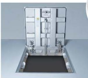
Schraub-Vorreiberverschluss inkl. einer Messing-Schutzkappe. Das Öffnen wird durch die hochwertigen Gasdruckfedern so unterstützt, dass die Schachtabdeckung von nur einer Person geöffnet und geschlossen werden kann. Eine Fallschutzvorrichtung verhindert das unkontrollierte Schließen. Die Aufbauhöhe beträgt 220 mm.
