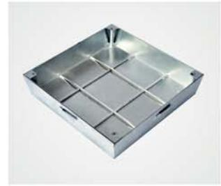
Die Zarge wird bodengleich einbetoniert. Anschließend kann die Wanne befüllt werden und in die Zarge eingelegt werden. Die Befestigung des Deckels an der Zarge erfolgt an den 4 Eckpunkten. Der Deckel kann an diesen Punkten mit dem Hebeschlüssel auch heraus genommen werden. Eine Befüllung mit Fliesen, Beton, Kunstharz, Granit, Terrazzoplatten, Holz und Hartbodenbelägen oder anderen Materialien ist möglich.
