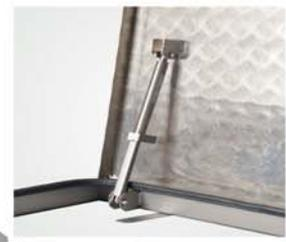
**Schachtabdeckung:** Stabiler Deckel aus 4 mm Riffel- oder Tränenblech aus Aluminium / Edelstahl, mit innenliegender Aufhaltevorrchtung (schützt vor unbeabsichtigtem Zufallen des Deckels / nur von Hand lösbar), mit selbsteinfallendem Verschluss und Messingovalkappe, nur mit Bedienschlüssel zu öffnen mit Gasdruckfeder als Öffnungshilfe, am Rahmen mit stabilen, verdeckten Scharnieren, Deckel ca. 100° aufklappbar, Lieferumfang mit Bedienschlüssel.
