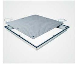
einbetoniert und der Deckel dann eingelegt. Die Befestigung des Deckels an der Zarge erfolgt durch eine 4-fach oder 8-fach Verschraubung an den gegenüberliegenden Seiten. Der Deckel kann an diesen Punkten mit dem Hebeschlüssel auch heraus genommen werden.
