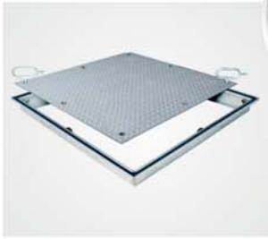
Die Zarge wird bodengleich einbetoniert und der Deckel dann eingelegt. Die Befestigung des Deckels an der Zarge erfolgt durch eine 4-fach oder 8-fach Verschraubung an den gegenüberliegenden Seiten. Der Deckel kann an diesen Punkten mit dem Hebeschlüssel auch heraus genommen werden.
