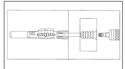
Maschine auf Linkslauf stellen und Schraube zurückdrehen, bis das Konstruktionsholz den gewünschten Abstand erreicht.
