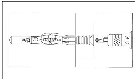
Holzlatte mit Jamoschraube anschrauben, bis Schraubenkopf min. 2 mm in der Holzlatte versenkt ist.
