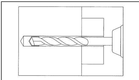
Mit Ø 8 mm Zebra-Hammerbohrer durch die Latte in Stein/Betonuntergrund.
