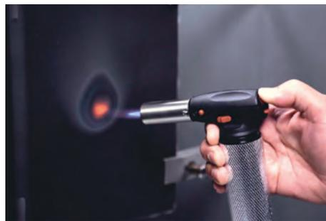
Mit Brandschutzklassifizierung Euroclass A2, s1-d0 bietet Stamisol Safe One eine sehr hohe Feuersicherheit für Fassaden.
