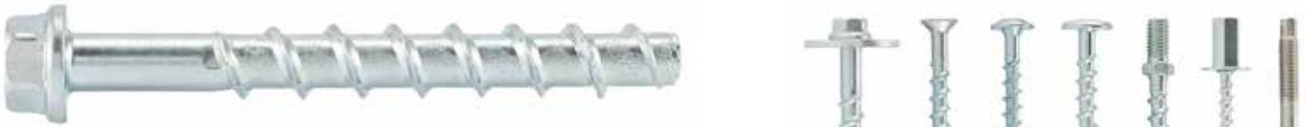
Beim Eindrehen der Betonschraube in den Beton schneidet die Betonschraube ein Gewinde in die Wand des Bohrlochs. Die Zuglasten werden durch mechanische Verzahnung (Formschluss) in den Untergrund eingeleitet. Betonschrauben können komplett und als Ganzes demontiert werden. Mit der Senkkopf-Betonschraube können Sie leicht oberflächenbündige Befestigungen realisieren.
