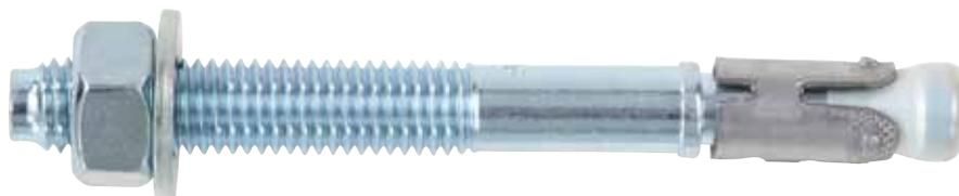
Der Fixanker W-FAZ leitet die äußeren Zugkräfte vorwiegend über Reibung in den Verankerungsgrund ein. Erhöht sich die Last, dann zieht sich der Konus tiefer in die Spreizhülse (= Nachspreizen). Verlässliches kontrolliertes Nachspreizen und höchste Montagesicherheit.
