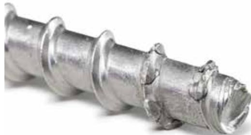
Die aufgeschweißten Schneidpunkte gewährleisten ein angenehmes Setzverhalten der rostfreien Variante. Aufgeschweißte Hartmetallspitzen entfallen, wodurch kein tieferes Bohrloch benötigt wird.
