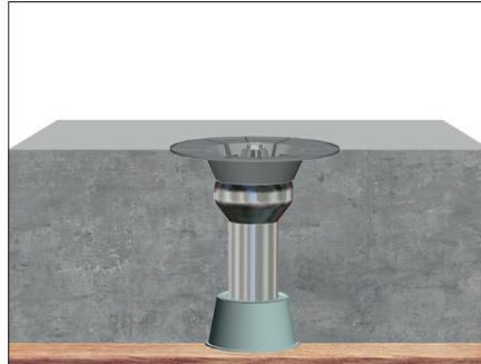
Grundkörper mit Schalungspilz\* und Schalungsglocke am Durchführungspunkt auf der Schalung verschrauben\*\*. Balkonplatte gießen. Zur leichteren Demontage wird empfohlen, die Schalungsglocke mit Schalungsöl zu benetzen.
