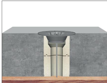
Wärmedämmkörper mit Schalungspilz\* am Durchführungspunkt auf der Schalung verschrauben\*\*. Balkonplatte gießen. Bei Muffenverbindungen in der Decke eine bauseitige Beschneidung der Wärmedämmung unterseitig durchführen. Einschublänge mit Cuttermesser ausschneiden.
