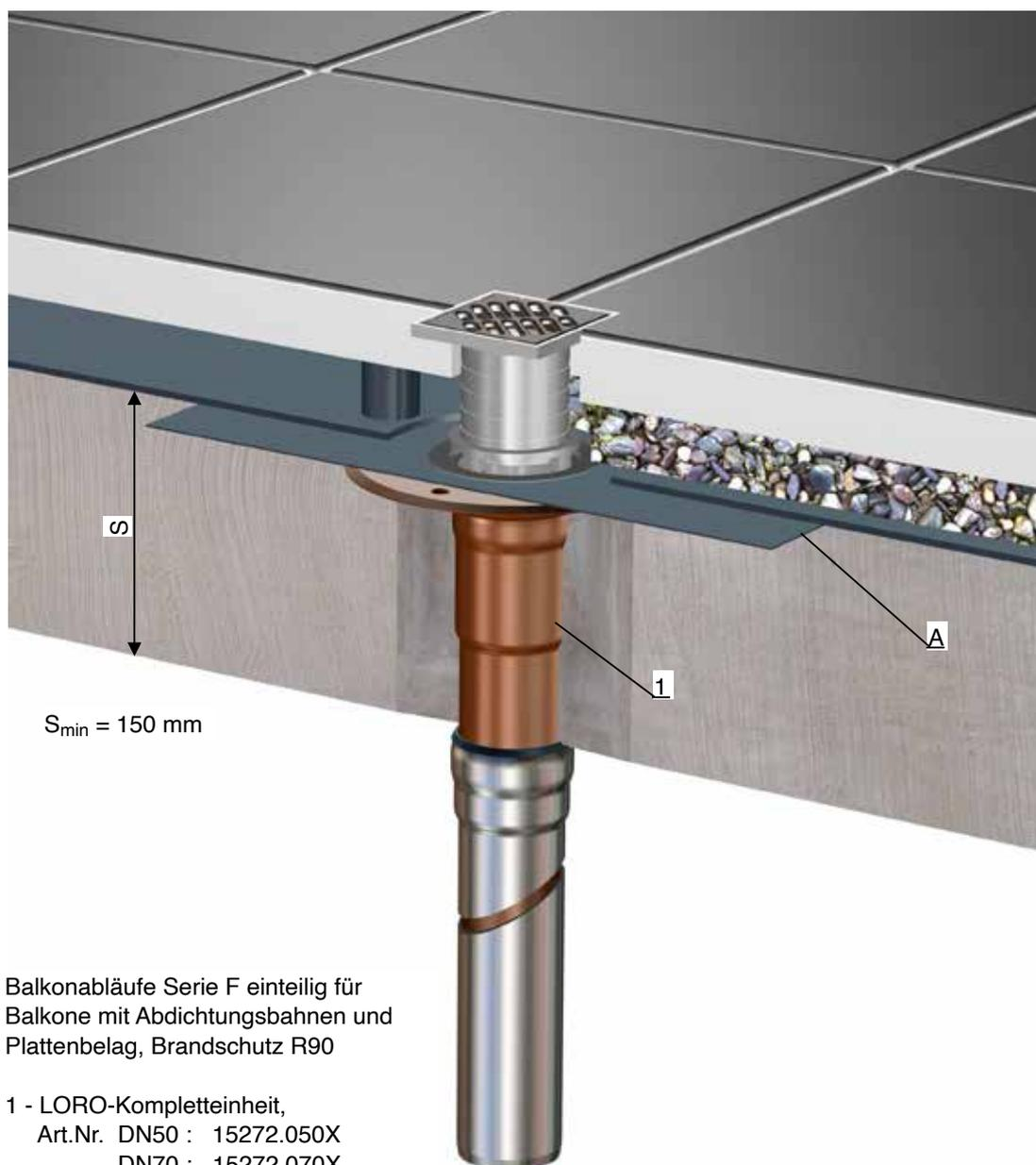
Balkonabläufe Serie F einteilig für Balkone mit Abdichtungsbahnen und Plattenbelag, Brandschutz R90
