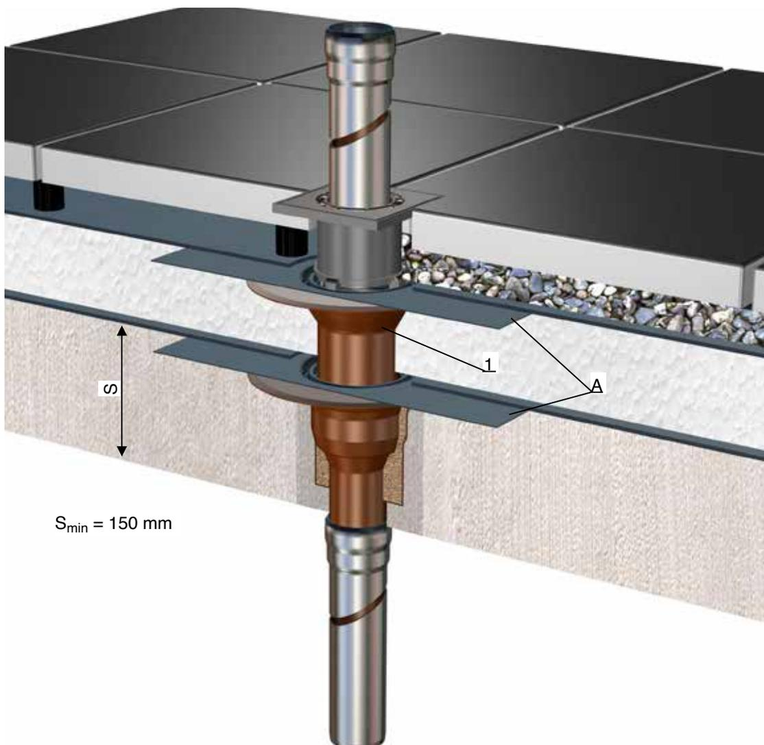
Direktabläufe Serie H zweiteilig für Balkone mit Abdichtungsbahnen und Plattenbelag,
