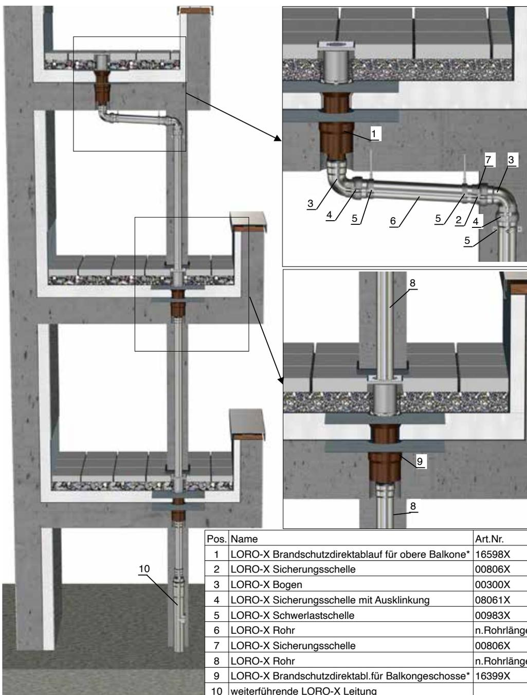
Bei einer Direktentwässerung, bei der die Rohrleitung senkrecht ohne Verzüge von Ablauf zu Ablauf geführt wird, sind keine Befestigungs- und Sicherungsschellen erforderlich, da die Rohrleitung automatisch in alle Richtungen gesichert ist.
