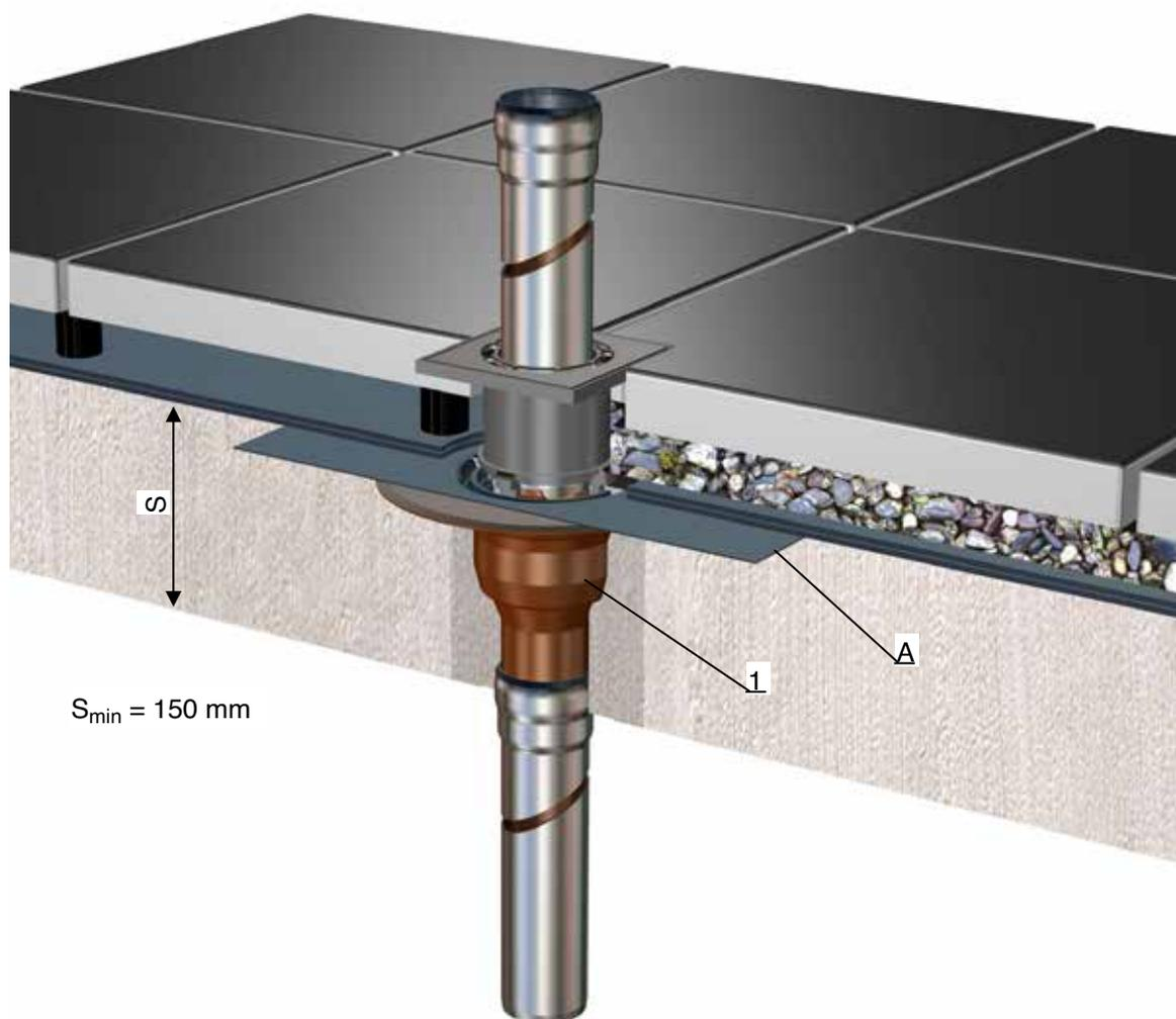
Direktabläufe Serie H einteilig für Balkone mit Abdichtungsbahnen und Plattenbelag, Brandschutz R90, gemäß ABP Nr.P-MPA-E-09-010 Punkt 2.2 und Anlage 9.
