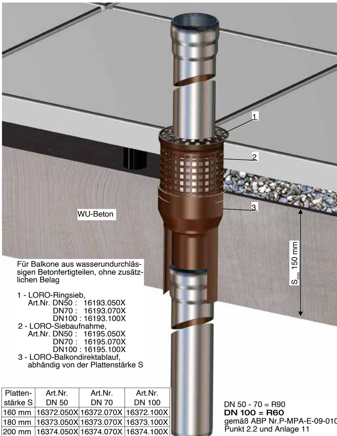
Für Balkone aus wasserundurchlässigen Betonfertigteilen, ohne zusätzlichen Belag
