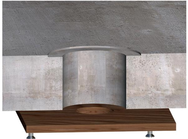
Schritt 3: LORO-Dachablauf in Öffnung einführen. Ablauf anheben und Ringspalt mit Mörtel der Baustoffklasse A1 verschließen.
