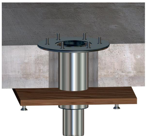
Schritt 5: Dampfsperre nach Vorgaben auf Seite 2 lochen und über den LORO-Dachablauf ausbreiten.
