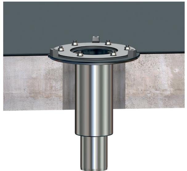
Bei Deckenstärken > 150 mm kann zur Verlängerung des Grundkörpers das LORO-Verbundrohr eingesetzt werden. Alternativ können quadratische Aussparungen nach folgender Tabelle vorgenommen werden.
