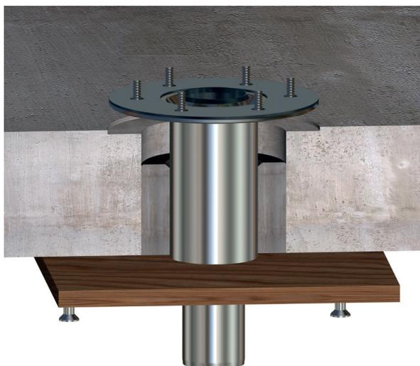
Schritt 4: Mörtel mit Betonoberfläche glatt streichen und LORO-Dachablauf in die richtige Position schieben. Restmörtel entfernen.
