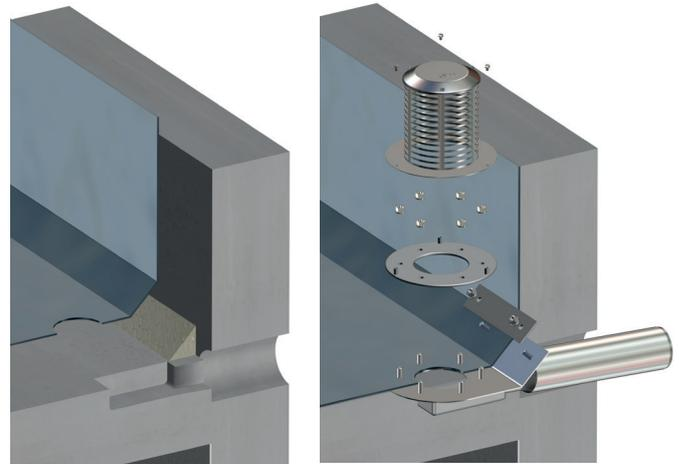
Das Auslaufrohr des Ablaufs bauseits in der Länge anpassen. Wärmedämmung im Bereich des Beckens des Ablaufes aussparen. Auslaufrohr im Wandbereich mit ausreichender Wärmedämmung versehen.
