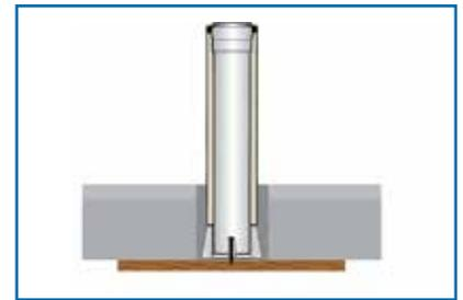
3. Aussparung ausgießen und Beton erstarren lassen.
