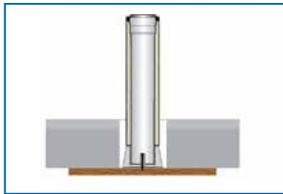
2. LORO-Schalungsglocke DN 70 bzw. DN 100 auf der Schalung befestigen und in die Aussparung einsetzen.
