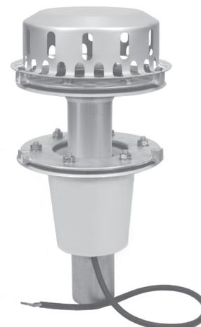
Beheizte Dachabläufe können in Einzelschaltung oder in Parallelschaltung angeschlossen werden. Automatische Zentralsteuerung erfolgt über Außenthermostate (bei Großanlagen zusätzlich über Hygrostate) und Zweipunktregler. Die dazu notwendigen Bauelemente sind, z.B. aus dem Bereich Heizungssteuerung, handelsüblich.
