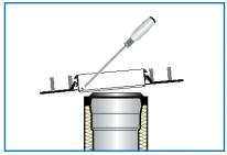
4. Ersten Schiebeflansch leicht schräg auf LOROFLEX Flachdachdurchführung aufsetzen, untere Lippe des Dichtelementes mit kreisförmiger Bewegung des Schraubendrehers aufschieben und Schiebeflansch in seine Einbauposition bringen.
