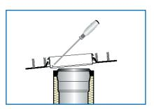
6. Zweiten Schiebeflansch leicht schräg auf LOROFLEX Flachdachdurchführung aufsetzen, untere Lippe des Dichtelementes mit kreisförniger Bewegung des Schraubendrehers aufschieben und Schiebeflansch in seine Einbauposition bringen.
