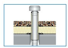
Bei Raumentlüftung zusätzlich Regenhaube aufstecken. LORO-Schalungsglocke entfernen. Ergebnis: Ein sauberer Anschluss, bei dem Nacharbeiten nicht erforderlich ist.
