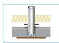
Ersten Losflansch über LOROFLEX Flachdachdurchführung aufschieben, Dampfsperre einbinden und Losflansch mit Schiebeflansch verschrauben\*. Wärmedämmung erstellen.
