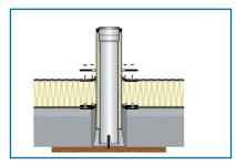
Zweiten Losflansch über LOROFLEX Flachdachdurchführung aufschieben, Dachabdichtungsbahnen einbinden und Losflansch mit Schiebeflansch verschrauben\*.
