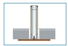
LORO-Schalungsglocke DN 70 bzw. DN 100 auf der Schalung befestigen und in die Aussparung einsetzen.
