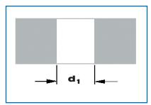
Aussparung (Kernbohrung) in Betondecke erstellen.
