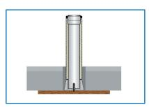
Aussparung ausgießen und Beton erstarren lassen.
