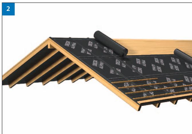
DELTA®-ALPINA wird verdeckt im Bereich der Höhen- und Seitenüberdeckungen mit Tackerklammern oder Breitkopfstiften geheftet. Wenn eine offene Befestigung unvermeidbar ist, wird diese mit einem Streifen DELTA®-ALPINA abgedichtet. Diese Punkte sollten auf ein Minimum begrenzt sein und nicht im Hauptwasserlauf z. B. vor Kehlen liegen. Die endgültige Befestigung von DELTA®-ALPINA erfolgt durch die Konterlatte.
