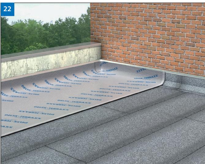
(Bild 22) An aufgehenden Bauteilen sollte die Dränbahn mindestens 15 cm bzw. bis zur Oberkante des fertigen Belages, mindestens aber bis zur Oberkante der hochgeführt werden.
