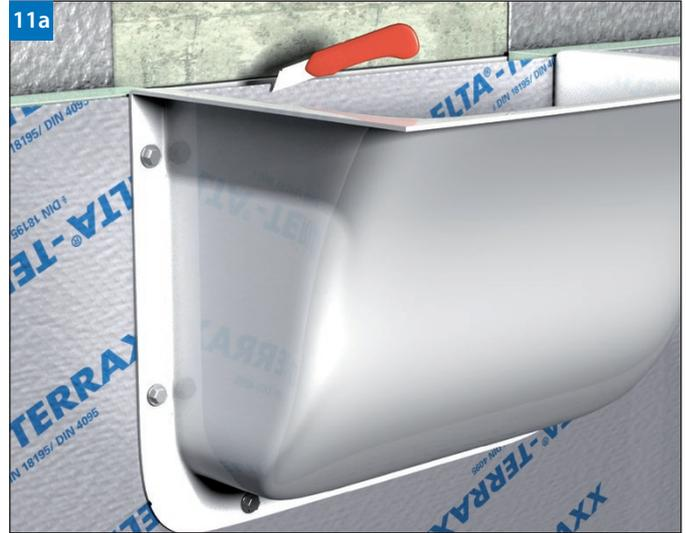
(Bild 11a) Kunststoff-Lichtschächte direkt auf die Bahn setzen.
