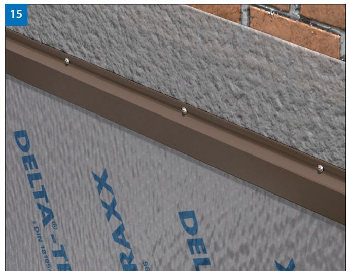
(Bild 15) Das DELTA®-NOPPENBAHNEN-PROFIL kann anschließend darüber montiert werden und die Befestigungspunkte abdecken.
