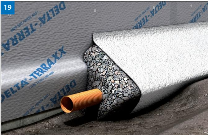
(Bild 19) Unten endet die Dränbahn DELTA®-TERRAXX dicht am Dränrohr. Die Dränleitung wird rundum mindestens 15 cm mit filterstabilem Material umgeben (z. B. Kies 16/32). Ist der Kies nicht filterstabil, muss die Kiespackung in ein Geotextil eingehüllt werden. Das Geotextil dabei nicht direkt um das Dränrohr wickeln, sondern immer um die komplette Kiespackung. Nur so ist eine dauerhafte Funktion gewährleistet.
