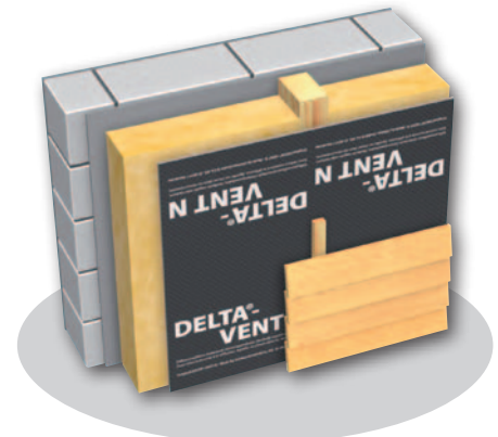
Beispiel einer Sanierung
