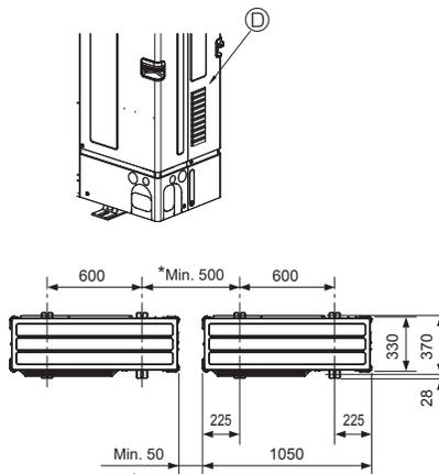
\* Bei Installation einer einzelnen Außenanlage beträgt der Freiraum mindestens 15 mm.
