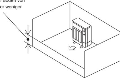
C) Für eine ausreichend große Belüftungsöffnung sorgen.
