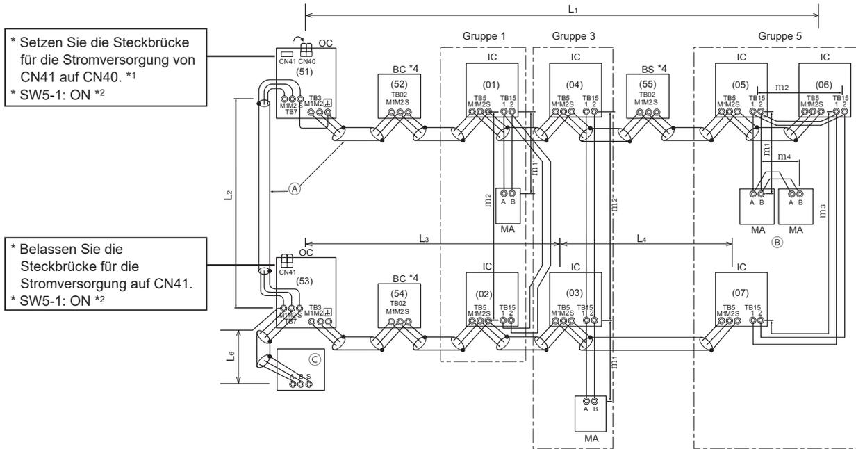
\*<sup>1</sup> Ist ein Netzteil nicht an das zentrale Kontroll-Übertragungskabel angeschlossen, setzen Sie in nur einem der Außengeräte die Steckbrücke für die Stromversorgung von CN41 auf CN40.
