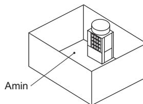
B: Das Gerät an einem Ort installieren, an dem die Wandhöhe  $\leq 0,125$  m ist.
