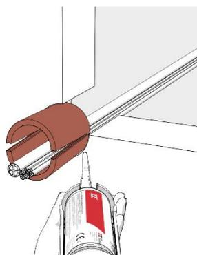
Bei Verwendung von **ZZ**<sup>®</sup> 603 Brandschutzrundbox sind die Fugen zwischen der Rohrschale und der Bauteillaibung mit **ZZ**<sup>®</sup> 300 oder **ZZ**<sup>®</sup> 333 Brandschutzmasse mindestens 20 mm tief, auf jeder Wandseite, auszufüllen.
