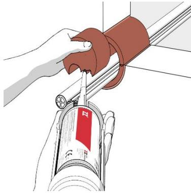
Stopfen strammsitzend in die Bauteilöffnung einsetzen. Der Luftspalt zwischen beiden Stopfen muss entweder 0 mm oder mindestens 30 mm betragen. **ZZ® 300** oder **ZZ® 333 Brandschutzmasse** zur Verfüllung von Kabelzwischenräumen, Zwickel und offene Fugen mit beidseitig mindestens 20 mm Verfülltiefe.
