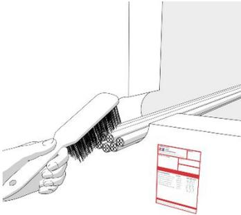
Bauteillaubung von Schmutz, Öl, Wachs und Fett reinigen.
