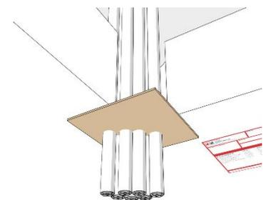
Bei größeren Öffnungen in Decken ist die Verwendung einer deckenunterseitigen Schalung zu empfehlen. Diese ist nach Fertigstellung des Schotts zu entfernen.
