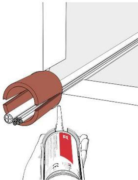
Bei der Verwendung der Schalle sind die Fugen zwischen den Schalungsrohren und der Bauteillaubung mit **ZZ**<sup>®</sup> 300 Brandschutzmasse, mineralischem Mörtel oder Gipsspachtel auf jeder Wandseite mindestens 20 mm tief auszufüllen. **ZZ**<sup>®</sup> 300 Brandschutzmasse gleichmäßig von hinten nach vorne in die Öffnung einbringen und Zwischenräume bzw. Zwickel abdichten. **ZZ**<sup>®</sup> 300 Brandschutzmasse kann zum Beispiel mit einem Glättspachtel abgeglättet werden.
