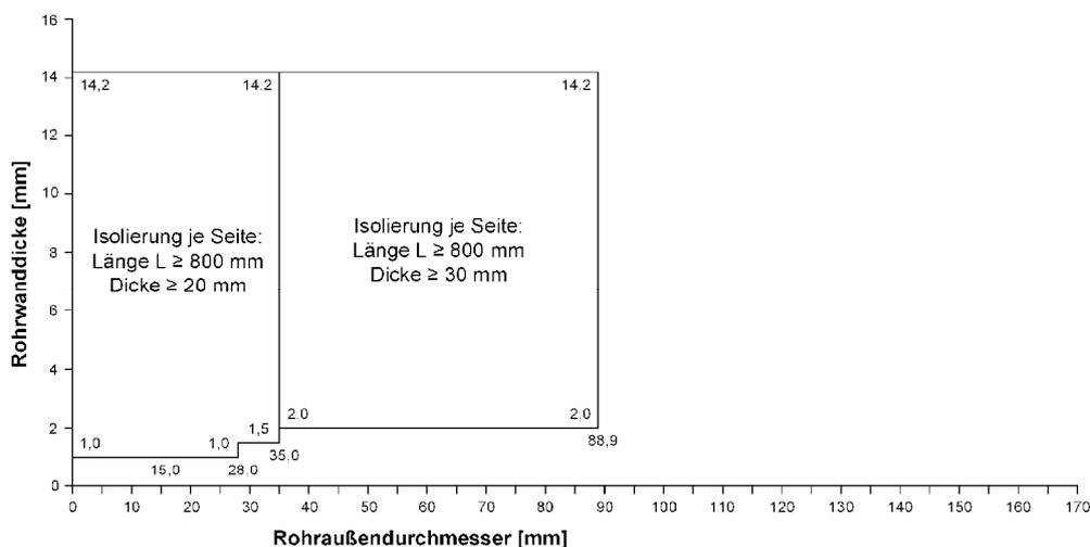
Die Streckenisolierung und der ggfs. vorhandene Mantel dürfen wahlweise durch die Abschottung geführt werden oder beidseitig an der Schottoberfläche angrenzen. Die Streckenisolierungen sind mit Spannbändern oder Draht zu befestigen (mindestens 6 Wicklungen pro lfd. Meter).
