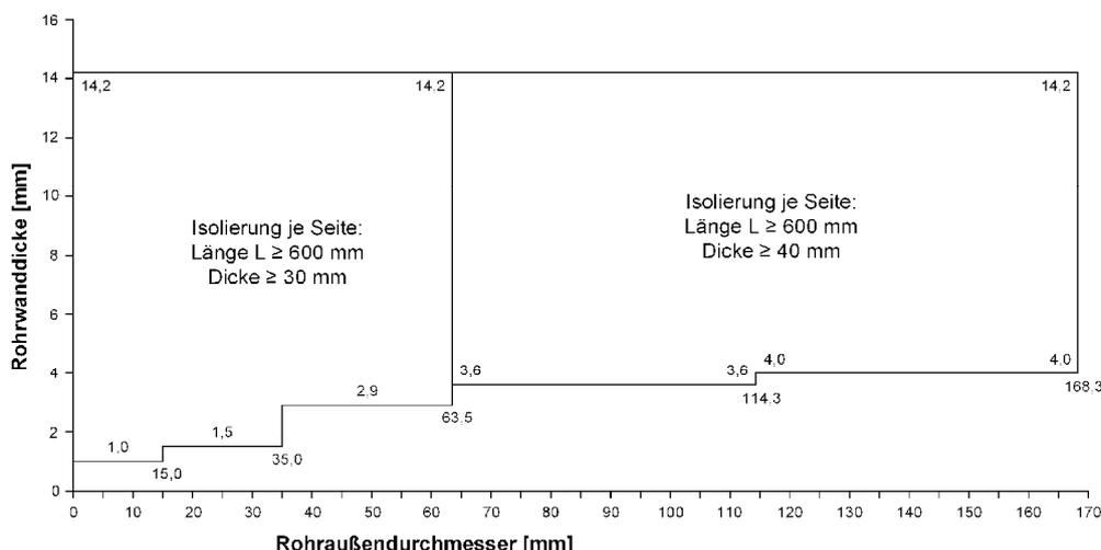
Rohre aus Kupfer mit Isolierungen/ Streckenisolierungen aus
