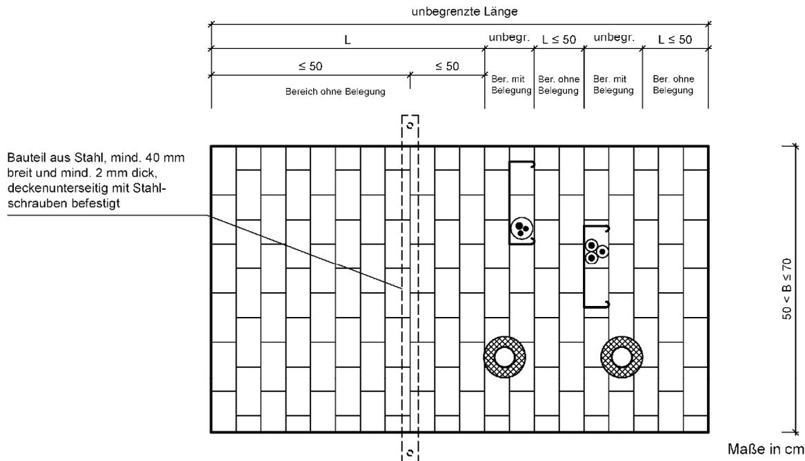
Bei Einbau in Öffnungen in feuerbeständigen Decken (s. Anlagen 7 und 8) mit einer Breite  $50 \text{ cm} < B \leq 70 \text{ cm}$  muss in feuerbeständigen Abschottungen ohne Belegung bzw. in Bereichen ohne Belegung mit einer Länge  $L > 50 \text{ cm}$  eine der folgenden Maßnahmen erfolgen:
