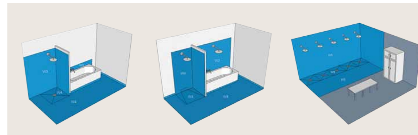
Abb. 1: Abdichtung beimäßiger Beanspruchung. Dusche ohne Kabine.
