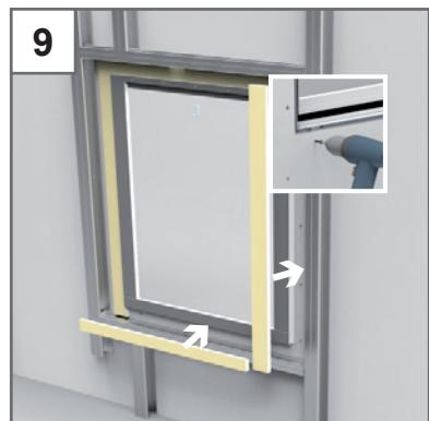
Die Anschlagleisten rückseitig am Rahmen des Revisionsverschlusses anschlagen und von vorne mit der Wand verschrauben (Bohrungsabstand  $a \leq 250\text{mm}$ ). Wechsel mit dem Wandprofil um Bauöffnung herum mit Abstand von ca. 70 mm herstellen.
