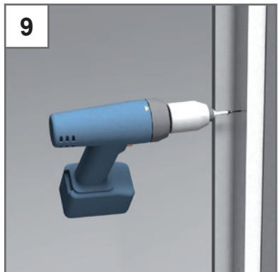
**Massivwände > 80 mm:** Die seitlichen Anschlageisten auf das Bauöffnungsmaß kürzen und die obere und untere Anschlageiste auf Bauöffnungsmaß minus 50 mm. Danach die Leisten rückseitig am Rahmen des Revisionsverschlusses anschlagen. Die Befestigungslöcher durch die Gipsleisten abbohren, dübeln und die Gipsleisten festschrauben.
