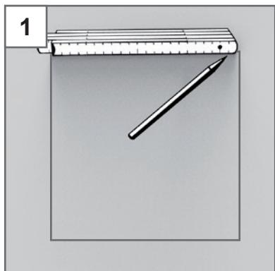
Bauöffnungsmaß anzeichnen und Öffnung aussägen bzw. beim Wandaufbau berücksichtigen. (Bauöffnungsmaß= Rahmenhöhe +20 mm/Rahmenbreite +10 mm)
