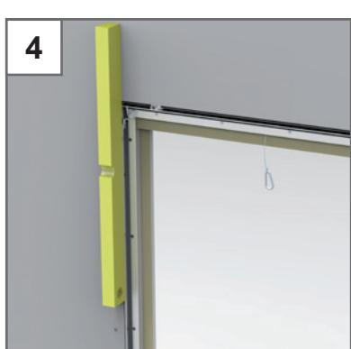
Rahmen in Bauöffnung einsetzen, mit den Montagekrallen ausrichten und leicht fixieren. Rechtwinkligkeit des Rahmens kontrollieren.
