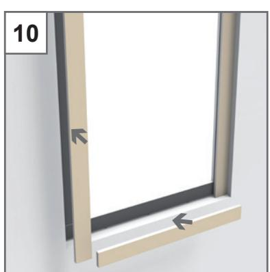
**Massivwände ≤ 80 mm:** Die Länge der seitlichen Anschlageisten auf das Bauöffnungsmaß kürzen und die obere und untere Anschlageiste auf Bauöffnungsmaß minus 100 mm kürzen. Die obere Anschlageiste in der Breite auf 35 mm zuschneiden. Danach die Leisten rückseitig am Rahmen und an der Wandkonstruktion anschlagen und zur Fixierung in ein Mörtelbett eindrücken.
