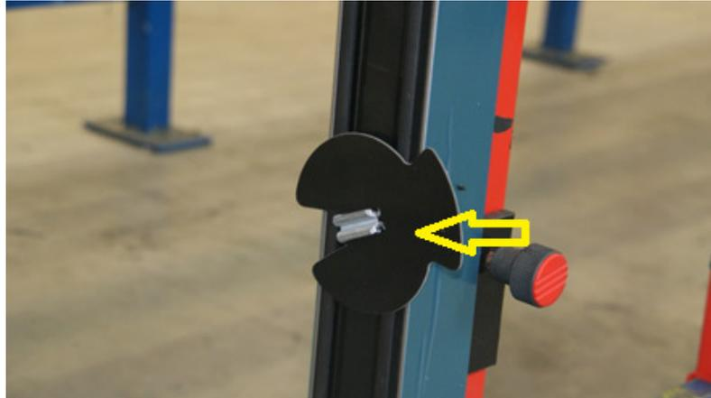
Lamellen gleichmäßig (mit 2 Mann) in die Drehlager einschieben. Die Lamellen sind nummeriert. Die Reihenfolge ist unbedingt einzuhalten.
