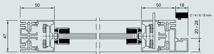
Elementbreite: Min. 250 mm / Max. 1600 mm
