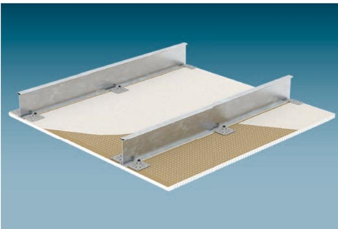
Knauf Cleaneo Contur Langfeld Elemente für Flurdecken ist eine revisionierbare, freitragende Unterdecke im Langfeldformat für verdeckte T-Schienensysteme. Die Elemente sind beidseitig auf Winkeln aufgelegt. Die Elemente sind leicht abnehmbar, was freien Zugang zum Deckenhohlraum ermöglicht und die Wartung von Versorgungsleitungen vereinfacht.
