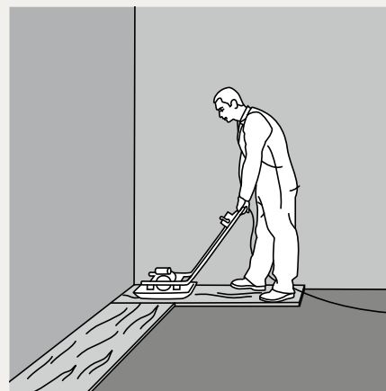
Alternative zu Handstampfer: Elektro-Flächenrüttler
