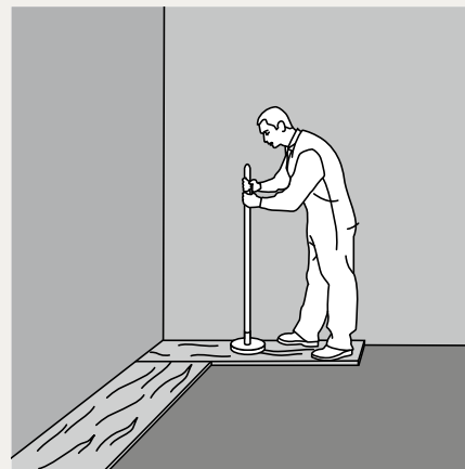
2. Schalttafeln oder OSB-Platten auf Abdeckplatten legen und vom Rand beginnend schneckenförmig nach innen mit Handstampfer verdichten
