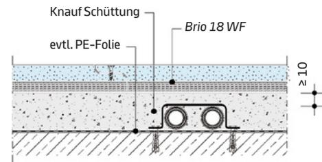
Zum Ausgleich von Unebenheiten sowie Installationen können außerdem der Knauf S 400 Sprint als schnelltrocknender, zementgebundener Leichtausgleichmörtel sowie Knauf EPO-Leicht eingesetzt werden. Mit Knauf EPO-Leicht lassen sich sogar sehr große Unebenheiten bis zu 800 mm ausgleichen.
