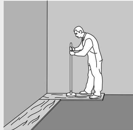
2. Schalttafeln oder OSB-Platten auf Abdeckplatten legen
